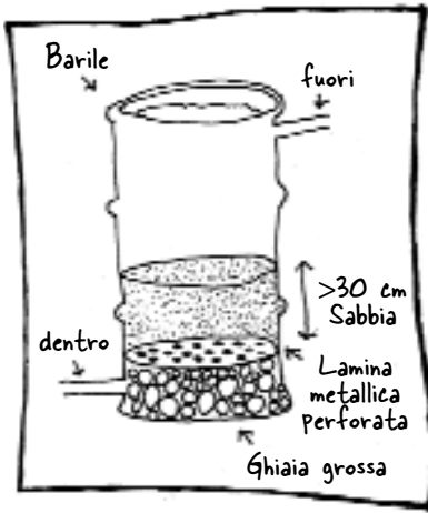
Figura 2.7 – Filtro Rapido a Sabbia. Il Filtro va collocato più in alto del Filtro Lento in modo che il Liquido sia spinto dalla Gravità
